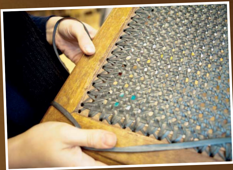
Ein neues Stuhlgeflecht: Statt traditionellem Rattan kommen hier ausgediente Fahrradschläuche zum Einsatz.
