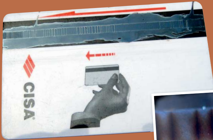
Bei einer magnetischen Schlüsselkarte, wie sie etwa in Hotels verwendet wird, ist nur eine Spur beschrieben.
