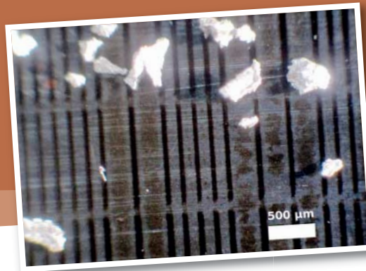
Die Stereotonspur eines Kassettenbandes im Detail
